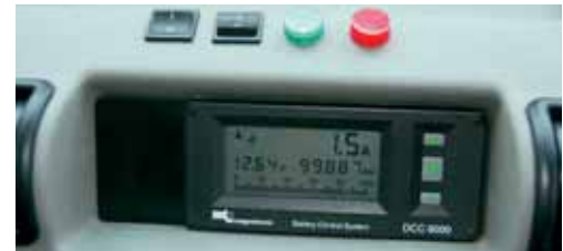
Im Innenraum verraten nur das Display für den Akkuzustand und zwei Schalter den Umbau, ...
