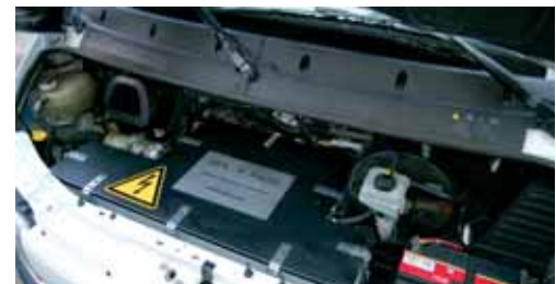
... unter der Motorhaube sitzt sauber eingepasst die Steuerelektronik für Antrieb und Batterie.
