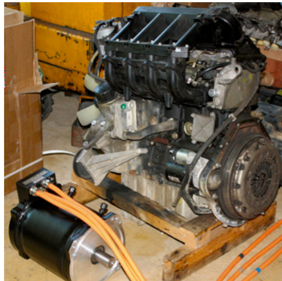
Synchron-Elektromotor (links) und Dieselaggregat im Größenvergleich
