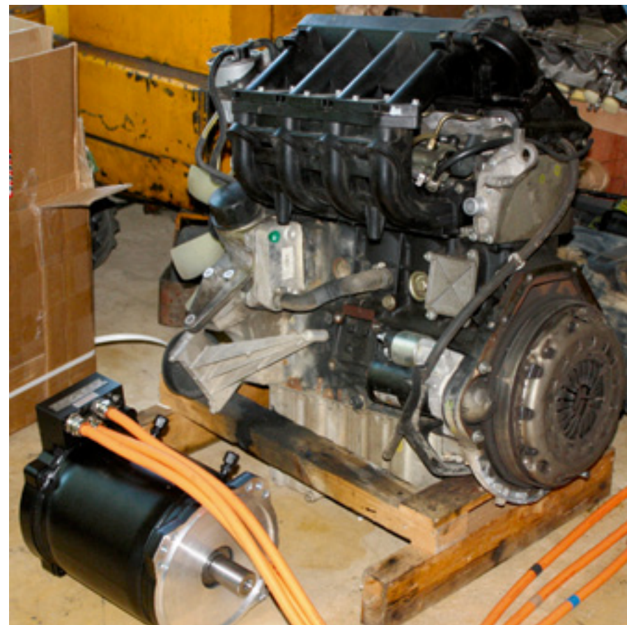
Synchron-Elektromotor (links) und Dieselaggregat im Größenvergleich
