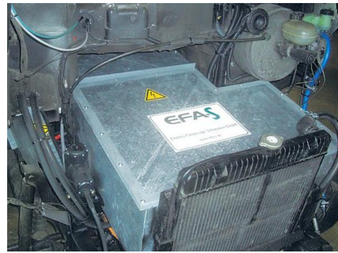
In Schwaben elektrifizierter UPS-Laster: Nach Dienstende des Diesels fährt der renovierte Wagen mit einem Elektroantrieb (unten) weiter. Die Treibstoffkosten halbieren sich dadurch
