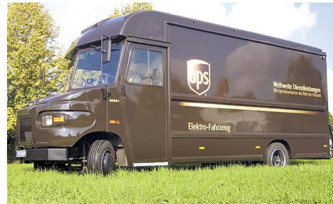
In Schwaben elektrifizierter UPS-Laster: Nach Dienstende des Diesels fährt der renovierte Wagen mit einem Elektroantrieb (unten) weiter. Die Treibstoffkosten halbieren sich dadurch
